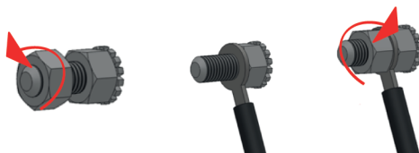
Rysunek 22. Podłączenie urządzenia do instalacji wyrównującej potencjały elektryczne.
